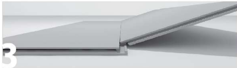
3 การวางพื้นไวนิลต้องให้ทับด้านร่อง และด้านเคียวเข้าหากันโดยทำมุมเอียง 45 องศา With 45 degree angle tilt embedded
