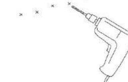
4. ใช้ส่วนไฟฟ้าเจาะผนังตามจุดที่มาร์คไว้ โดยใช้ดอกสว่านเบอร์ 5 จะเท่านั้น (ดอกสว่านควรเป็นเบอร์เดียวกับกับสกรู)
